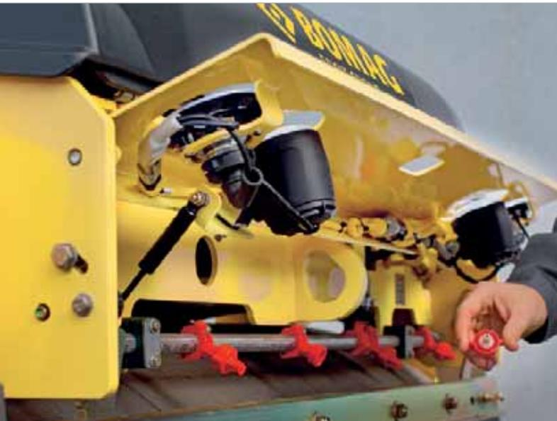
Robusto e di facile manutenzione: il sistema di spruzzatura è posizionato al riparo dal vento, dietro al telaio anteriore e posteriore.
